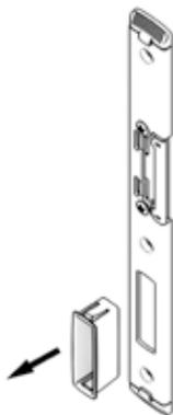
2. Distanzplatte aufsetzen (nur bei U-Schließblechen)
