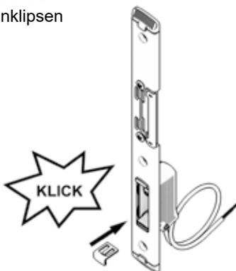
5. Fertig montiertes Schließblech mit Riegelschaltkontakt
