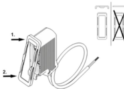
3. Riegelschaltkontakt einhängen
