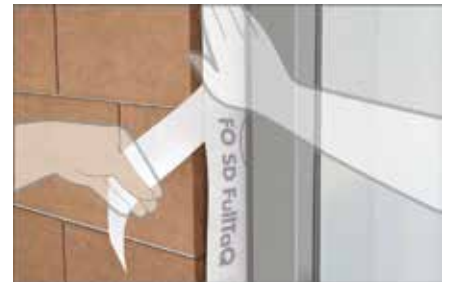
3 Breiten Streifen des Trennpapiers abziehen und Folie spannungsfrei am Baukörper ankleben.
