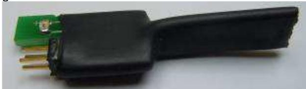
Abbildung des Servicedongles, die Nase dient als Verpolschutz
