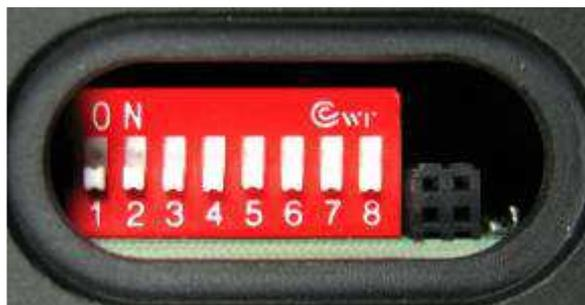
Abb. 1: DIP-Schalter (alle Schalter auf "0")
