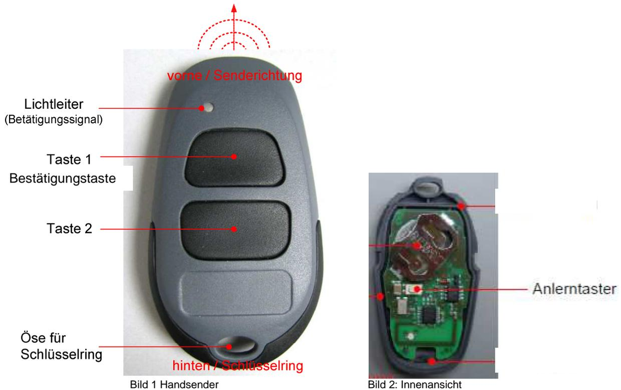
Der Handsender hat zwei Bedientasten. Ein erkannter Tastendruck wird durch ein kurzes Blinken einer LED am Lichtleiter signalisiert. Die Taster besitzen einen fühlbaren Druckpunkt, in leiser Umgebung ist ein Klicken hörbar.
