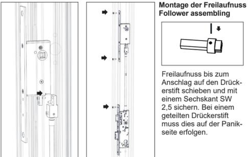
Freilaufnuss bis zum Anschluss auf den Drückerstift schieben und mit einem Sechskant SW 2,5 sichern. Bei einem geteilten Drückerstift muss dies auf der Panik-seite erfolgen.
