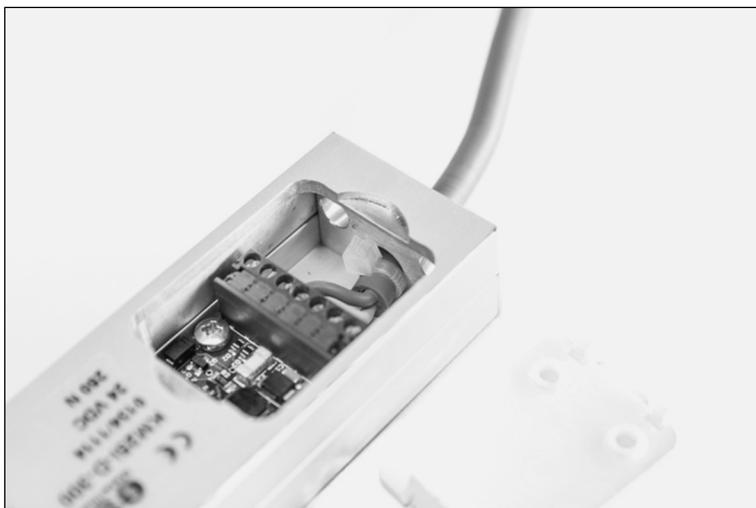
Stecker einsetzen und Kabel bis Zugentlastung herausziehen.
